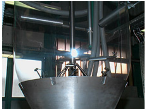
Drehkern-Kopf und Intensiv-Luftkühlssystem sorgen für Qualitäts- und Wirtschaftlichkeitssteigerung bei der Blasfolienextrusion (Fotos: Dr-Pack)
